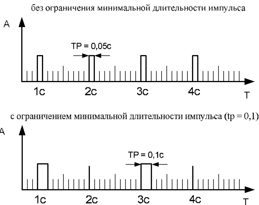
Рисунок 5 – Диаграммы работы ШИМ-модулятора без ограничения минимальной длительности импульса и с ограничением
